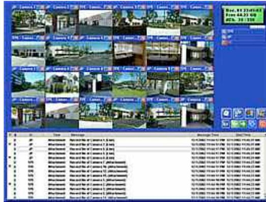
Con Center , la estación de monitoreo central (CMS) puede ser utilizada inmediatamente porque reúne múltiples sistemas de VD en una interfaz integrada, permitiendo al operador manejar varios sistemas desde un punto de control. La función fundamental de Center V2 es vincular evidencia de video con cualquier alerta que se envía a Center V2, lo que ayuda al operador final remoto a determinar la naturaleza de la alarma.
