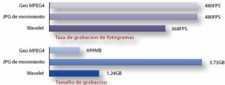
**Nota:** ambas pruebas se realizaron utilizando grabación VD-1000 con 16 canales. El tamaño de grabación se calculó utilizando grabación VD-1000 a 480 fps (30 fps x 16 cámaras) durante 15 minutos.
